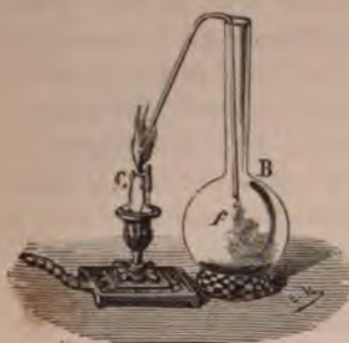
Fig. 54. — Décantation des gaz de la flamme.
